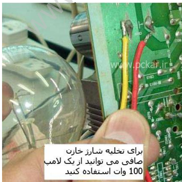
شکل ۱۰،۵- روش صحیح تخلیه خازن صافی با لامپ
