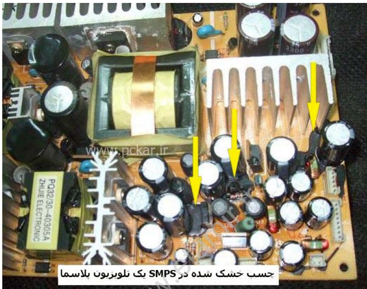
شکل ۱۵،۱۲ - چسب خشک شده در برد مدار
