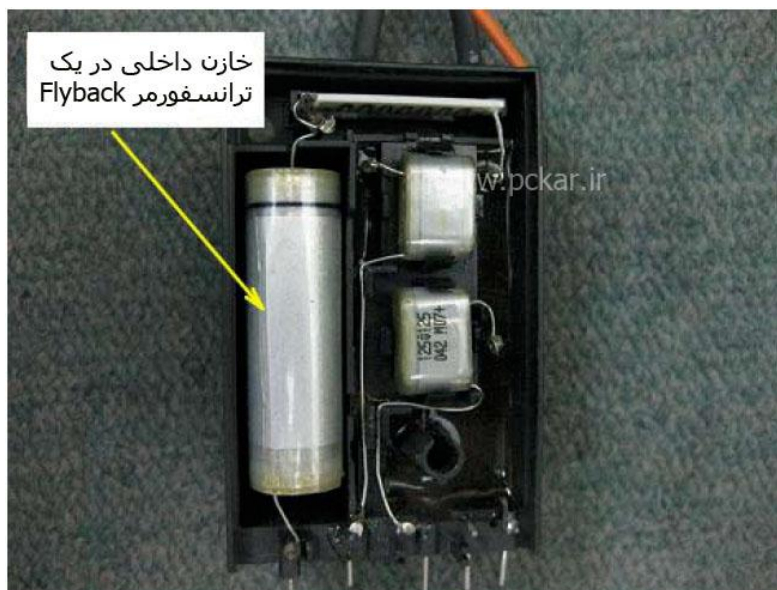
شکل ۱۸،۱۵ - یک خازن در بخش داخلی ترانسفورمر Flyback
