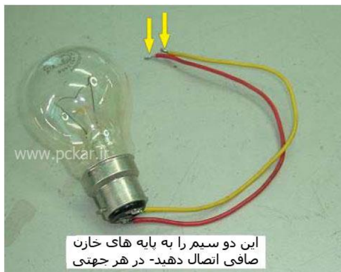
شکل ۱۰-۴- لامپ ۱۰۰ وات که برای تخلیه خازن صافی استفاده می شود
