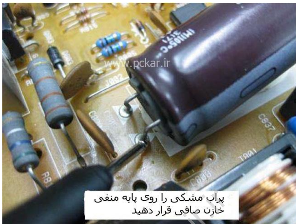
شکل ۱۱,۷ - نحوه صحیح قرار دادن پراب مشکی
