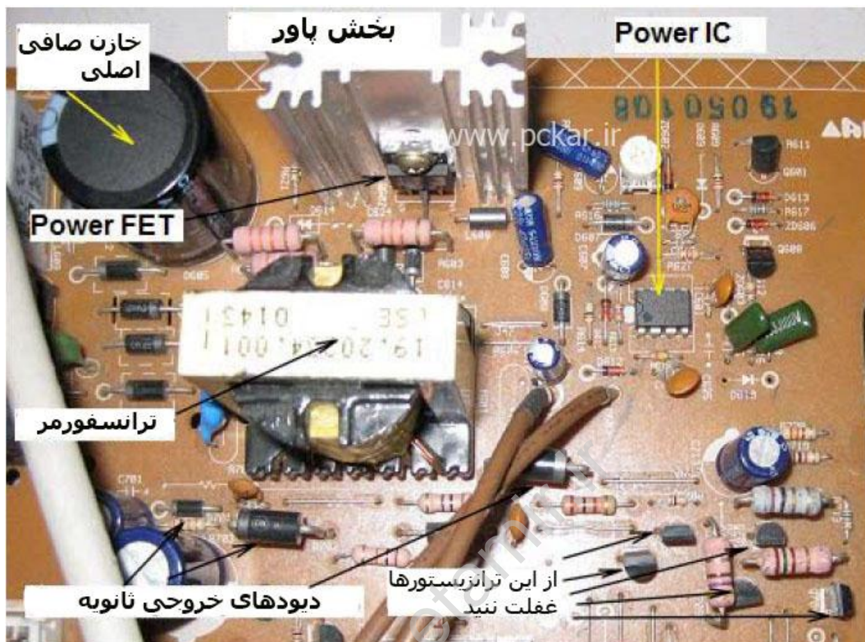
شکل ۱۸،۸ - یک ترانزیستور دارای نشی در بخش ثانویه می تواند باعث ایجاد افت ولتاژ خروجی شود
