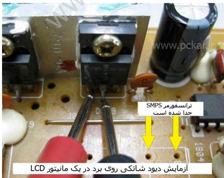
شکل ۱۵،۵ - نحوه صحیح آزمایش دیود شاتکی روی برد
