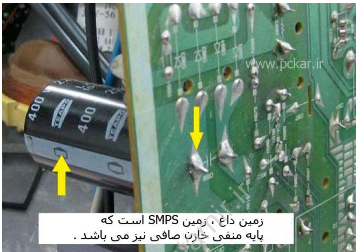
شکل ۸،۳ - تشخیص زمین داغ در برد مدار
