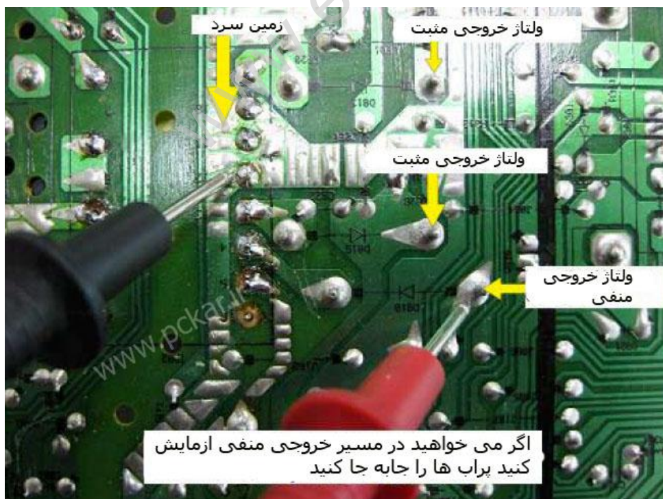
شکل ۱۴,۸ - اگر می خواهید مسیر خروجی منفی را آزمایش کنید پراب را جابه جا کنید
