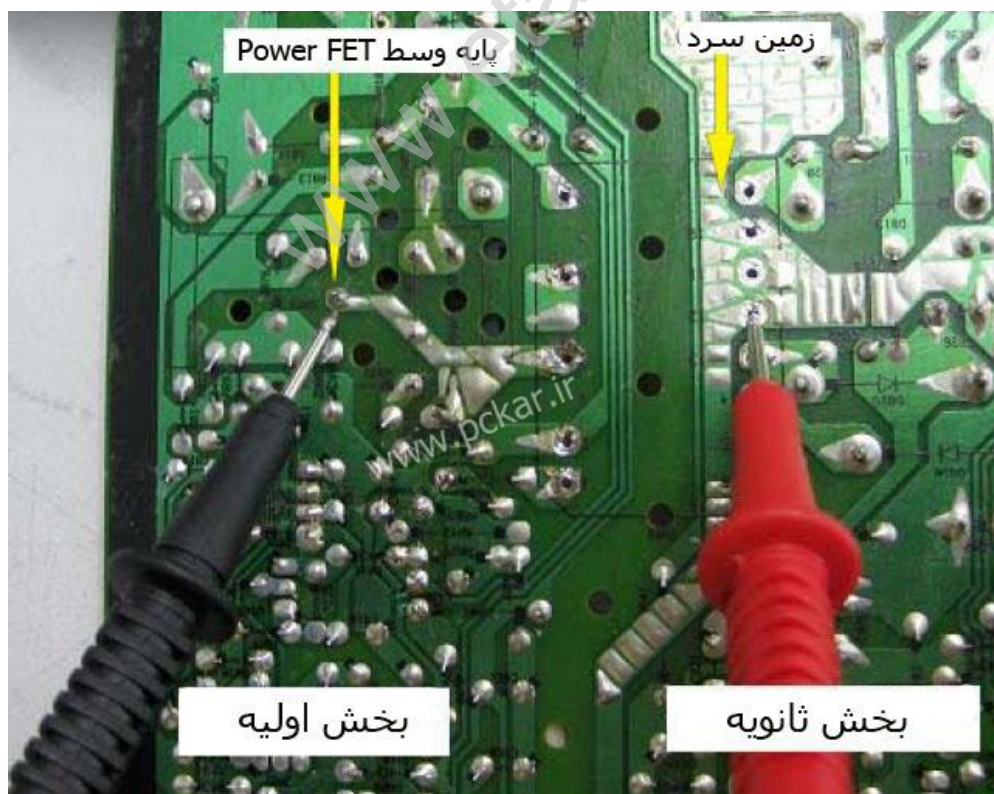
شکل ۱۴,۵ - نحوه صحیح قرار دادن پراب های آزمایش
