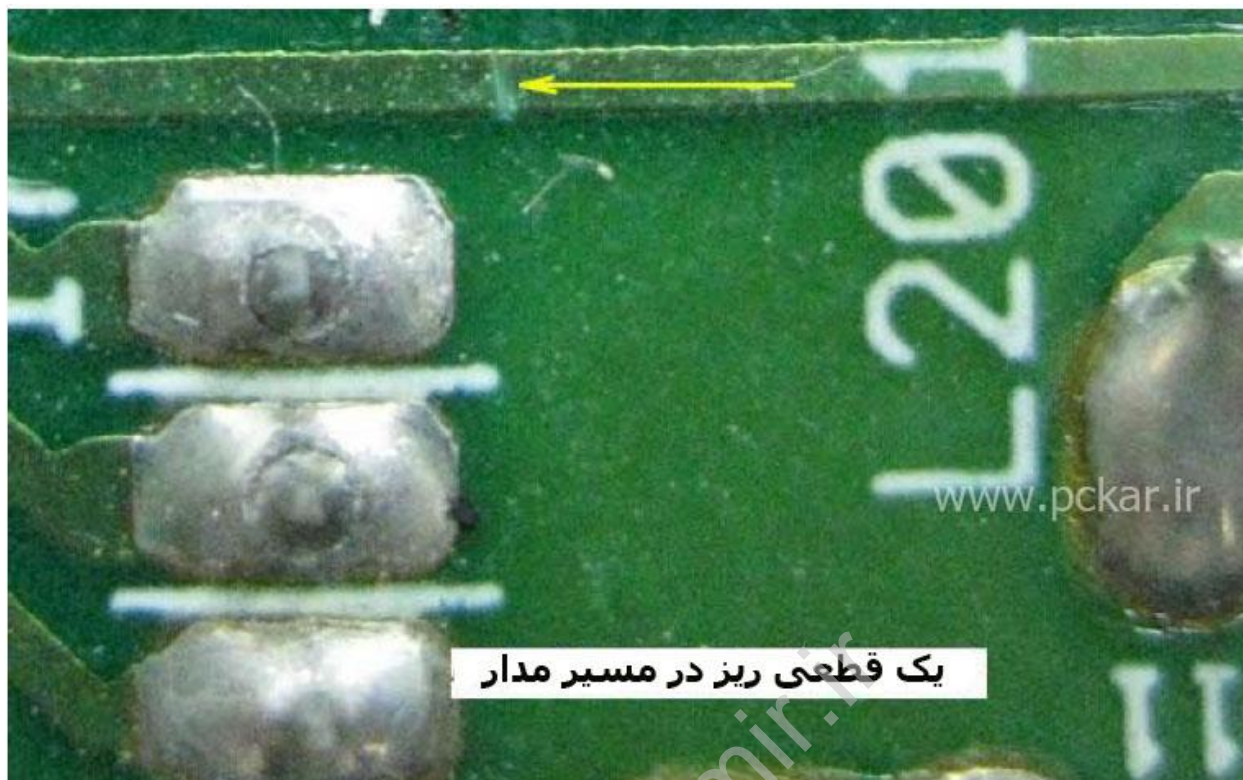
شکل ۱۸,۱۱ - یک قطعی در مسیر مدار
