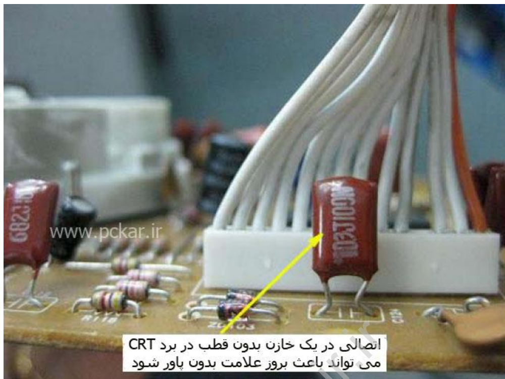
شکل ۱۸،۱ - خازن بدون قطبیت اتصالی کرده در برد CRT
