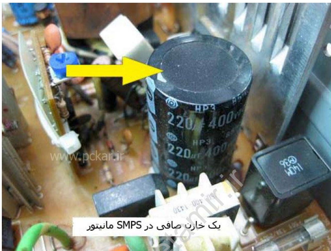
شکل ۵,۷ - خازن صافی در بخش اولیه SMPS
