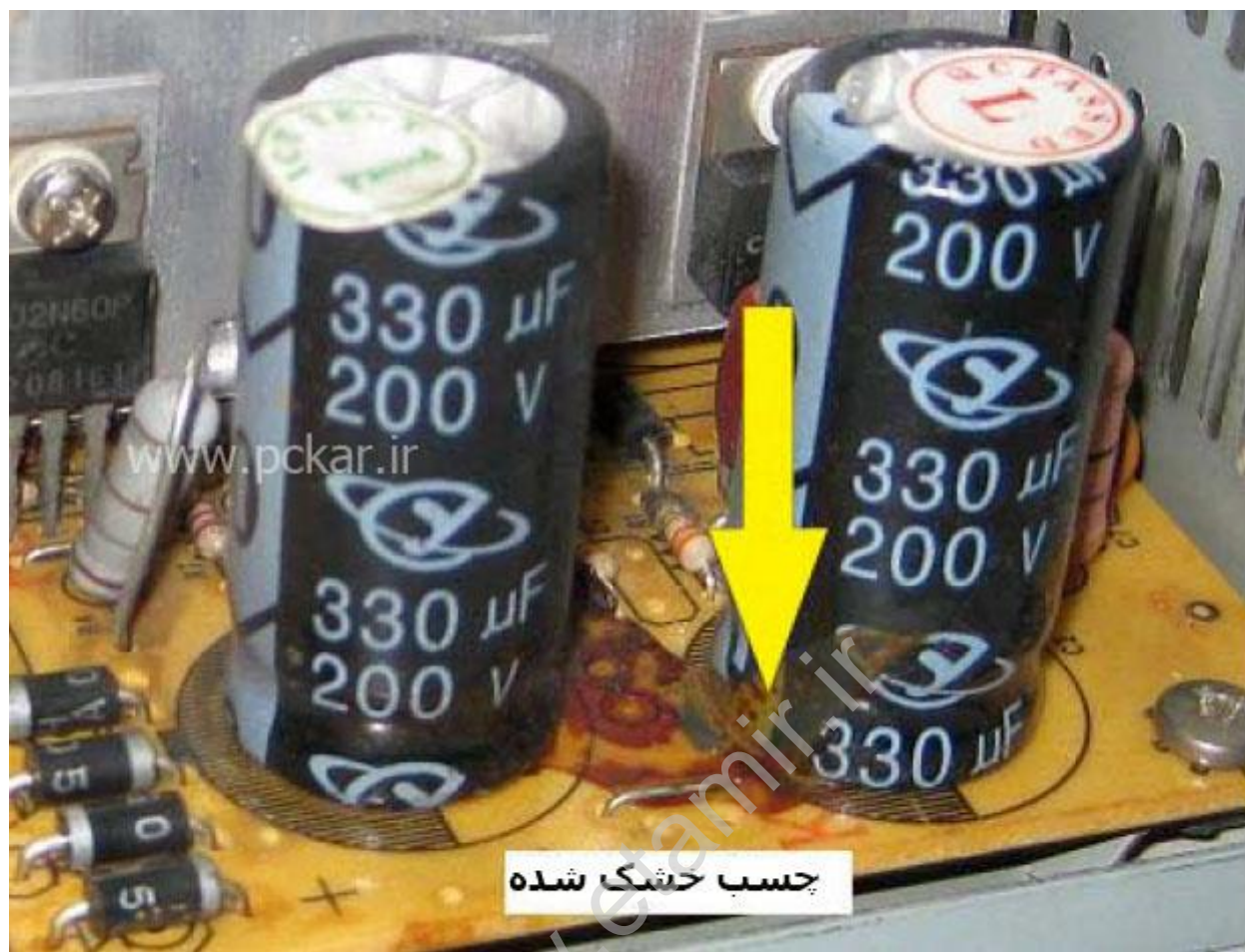
شکل ۲۰،۴ - چسب خشک شده در منابع تغذیه ATX
