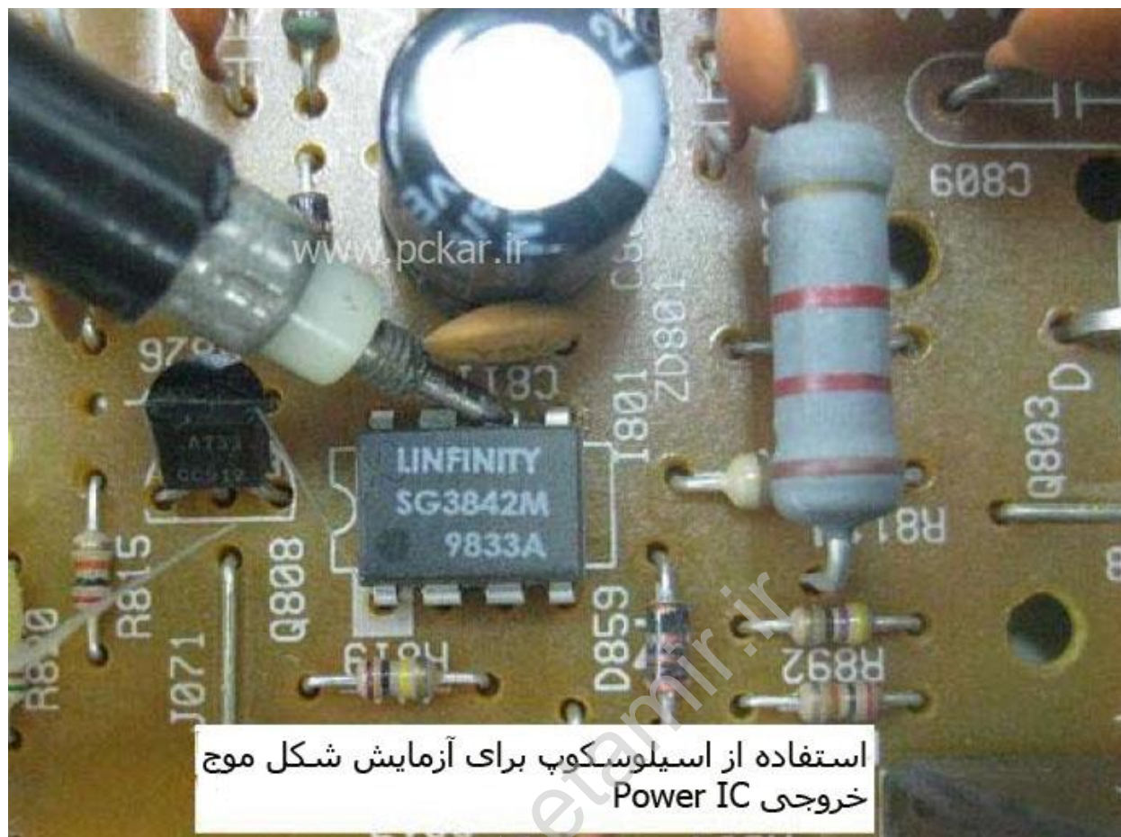
شکل ۱۲،۲ - نحوه صحیح قرار پراب اسکوپ روی پایه Power IC
