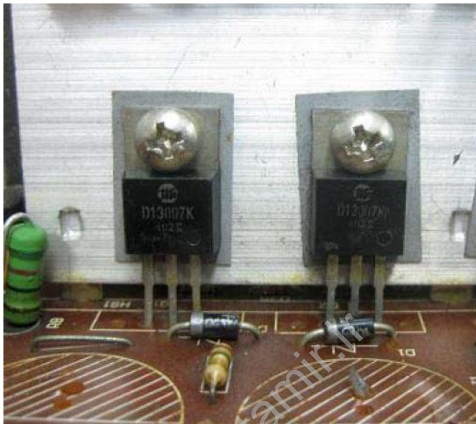
شکل ۱، ۲۰ - ترانزیستورهای پاور در منبع تغذیه ATX
