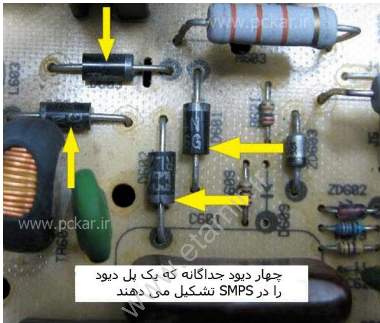
شکل ۵،۵ - چهار دیود که پل دیود را تشکیل می دهند
