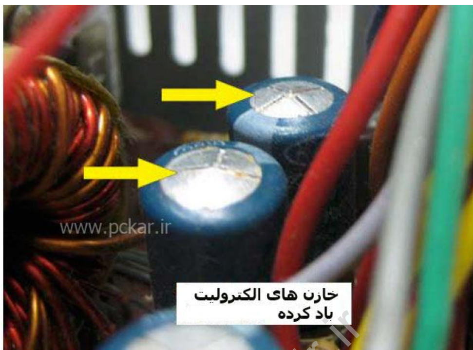
شکل ۱۰، ۲۰ - خازن های الکترولیت باد کرده
