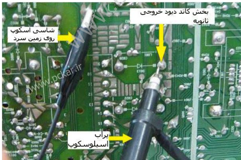
شکل ۱۲،۱۴ - می توانید پراب اسکوپ را در پشت برد قرار دهید
