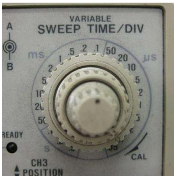
شکل ۱۲,۷ - Time Per Division را تنظیم کنید
