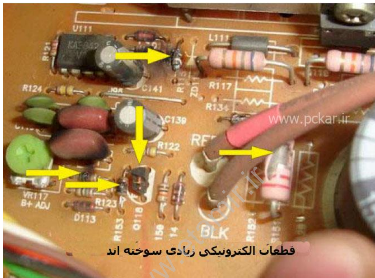
شکل ۱۶،۱ - قطعات زیادی در برد مدار سوخته است
