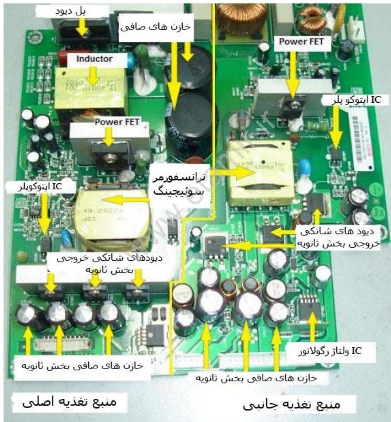
شکل ۲،۱ - SMPS یک نمونه تلویزیون LCD
