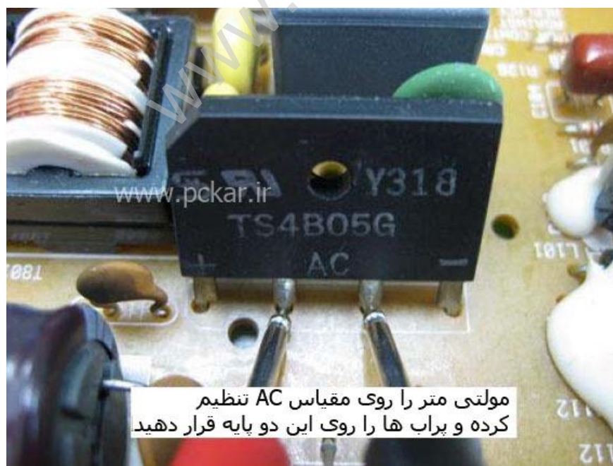
شکل ۱۱،۲- پراب ها را در نقاط صحیح قرار دهید
