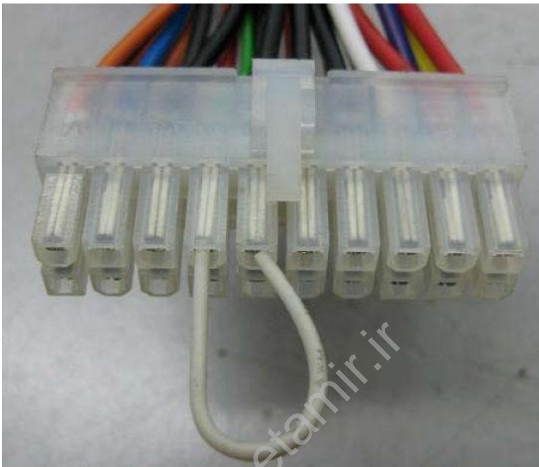
شکل ۱۹،۱۳ - این روش اتصال بین سیم سبز و زمین است
