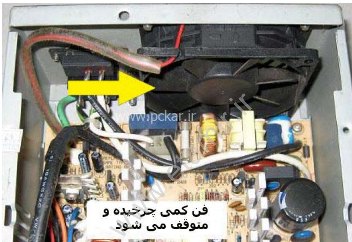
شکل ۱۹،۱۵ - فن مدتی چرخیده و متوقف می شود
