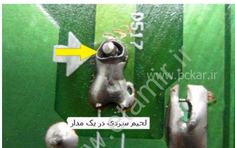
شکل ۱۵،۱۰ - لحیم سردی های موجود در مدار را جستجو کنید
