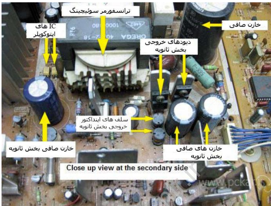
شکل ۲,۴ - SMPS تلویزیون CRT Sony
