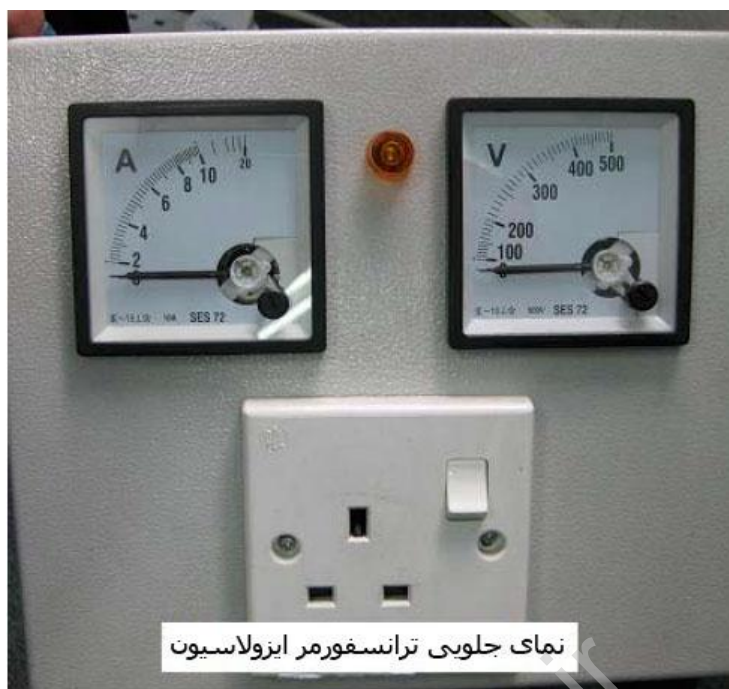
شکل ۷,۳ - قسمت جلویی ترانسفورمر ایزولاسیون
