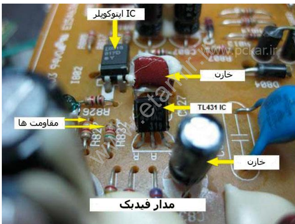
شکل ۱۵,۷ - مدار فیدبک SMPS شامل IC اپتوکوپلر ، TL431 IC ، مقاومت ها و خازن ها است
