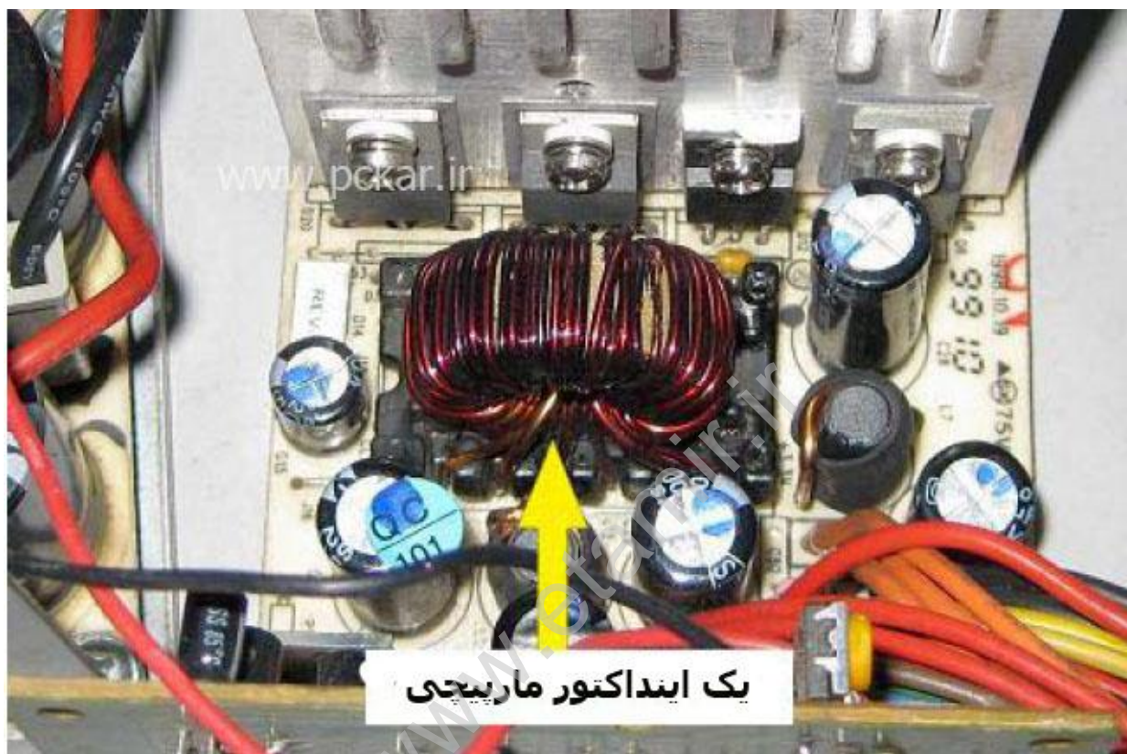
شکل ۲۰,۹ - اگر قطعات مجاور سالم بودند سلف ماریپیچی را تعویض کنید
