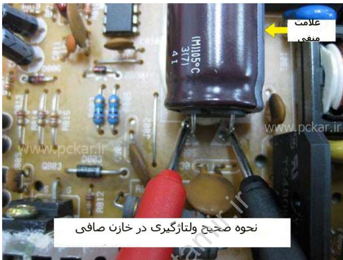
شکل ۱۱،۵ - ولتاژگیری در پایه های خازن صافی
