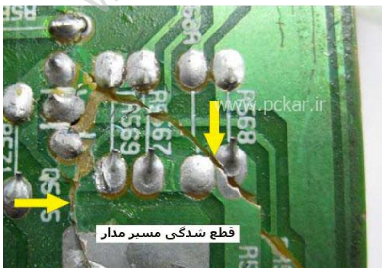
شکل ۱۵،۱۱ - بررسی کنید برد ترک ندارد
