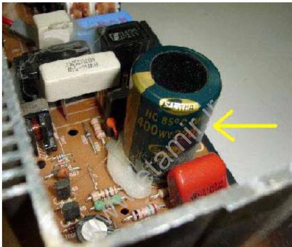
شکل ۱۰،۲ - خازن صافی بزرگ در منبع تغذیه مانی‌تور CRT
