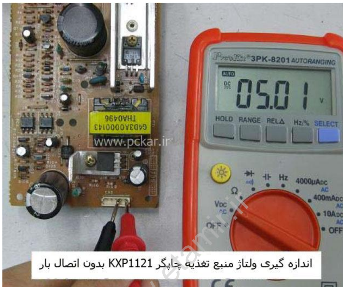
شکل ۱۱، ۱۲ - آزمایش ولتاژ خروجی منبع تغذیه بدون اتصال بار
