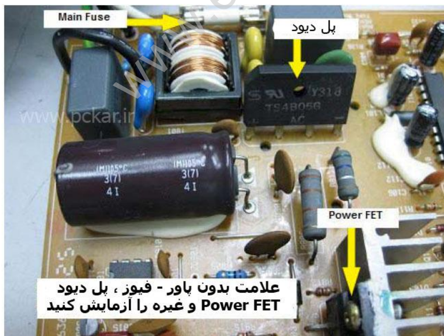
شکل ۹،۲ - روش پایه ای پیدا کردن خرابی
